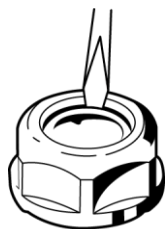
图5-7 交流输出线接线（剥去密封圈）
